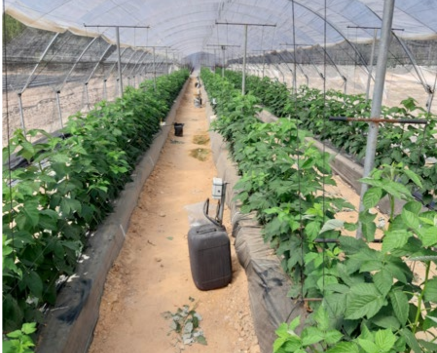
Recogida del agua de drenaje de los lisímetros para su posterior análisis químico
