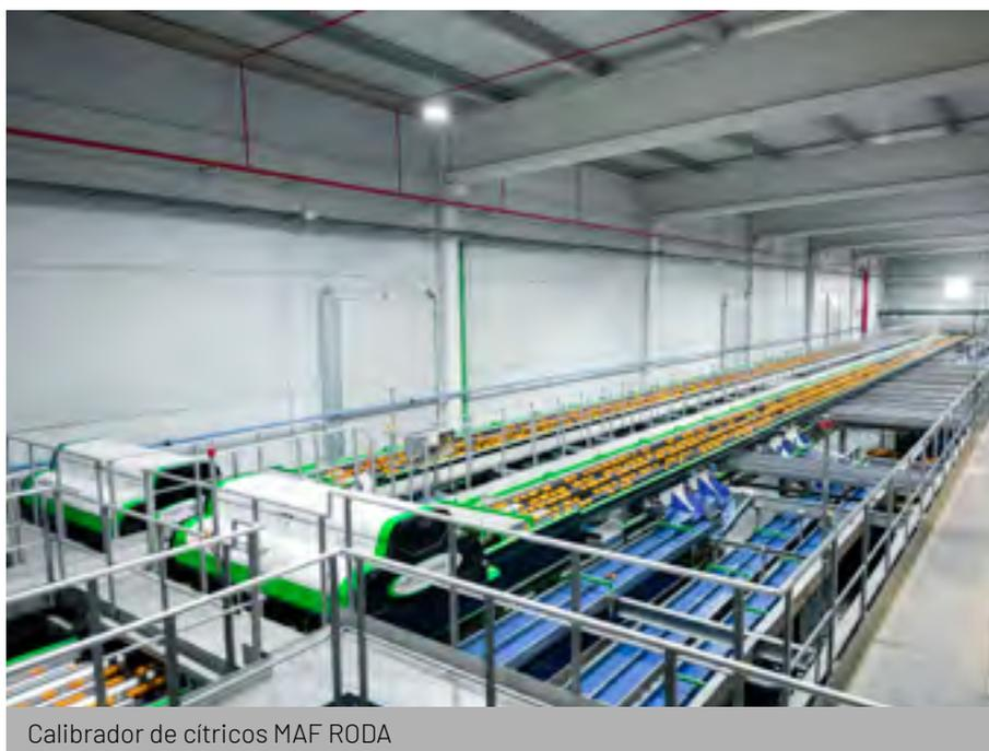
Calibrador de cítricos MAF RODA
